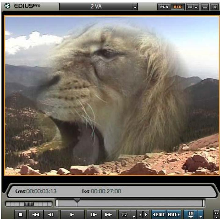
L'immagine del video 2VA apparirà progressivamente, sotto forma di un cerchio sfumato sul bordo, sopra l'immagine 1VA. Volendo è possibile regolare le dimensioni del bordo sfumato variando il valore che abbiamo settato precedentemente a 20.
